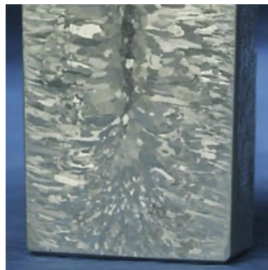
Obr. 2.7 Štruktúra rezu hliníkového odliatku odliateho do kovovej formy.
