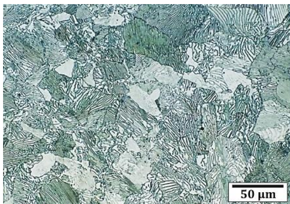
Obr. 1.3 Mikroštruktúra eutektoidnej ocele s 0,78 hm. % C (lamelárny perlit).
